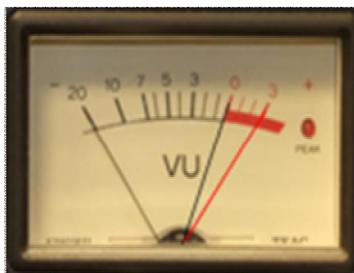
**Zero VU:** + 4 dBm (+ 4 dBm a 600 ohms)
